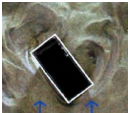
Figura 22: Esperimento di laboratorio, Dipartimento di Idraulica, Università di Pavia. Vista dall'alto di uno ostacolo rettangolare posto su letto sabbioso in seguito a simulazione.
